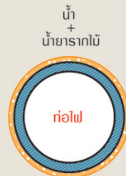
ตะกรันตกตะกอน ผิวท่อถูกเคลือบด้วยน้ำยารากไม้
